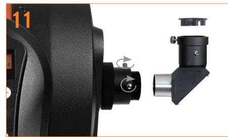
11 Rimuovere il tappo dalla parte posteriore del telescopio. Inserire il barilotto argentato del diagonale stellare nel visual back come mostrato sopra. Serrare la vite di regolazione argentea per fissare.
