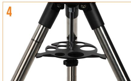
Deslice la bandeja de accesorios sobre la vara estriada de forma que cada brazo de la bandeja se apoye en cada pata del trípode. Vuelva a colocar y apriete el mando de bloqueo de la abrazadera de la pata para asegurar con firmeza la bandeja en posición.
