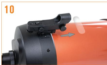
10 Fare scorrere il cercatore a puntino rosso StarPointer sulla staffa di montaggio e serrare le viti poste a lato del cercatore StarPointer per fissarlo in posizione. Estrarre la linguetta in plastica da sotto il coperchio della batteria per consentire alla batteria di fare contatto.
