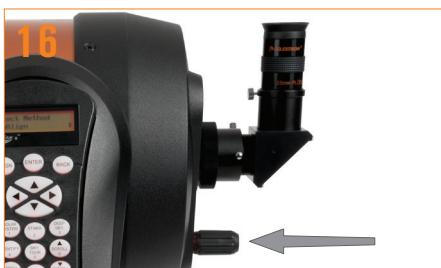
16 Per ottenere una visione ottimale attraverso il telescopio, ruotare lentamente la manopola di messa a fuoco fino a quando gli oggetti sono a fuoco.
