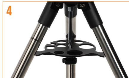
Faites glisser le plateau à accessoires sur la tige filetée de sorte que chaque bras du plateau s'appuie contre chaque pied de trépied. Replacez et serrez la molette de verrouillage du renfort de jambe pour fixer fermement le plateau en place.
