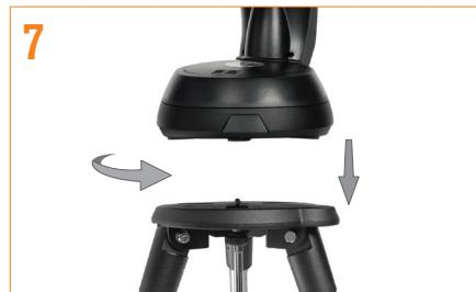
Setzen Sie den Sockel des Teleskops auf den Stativkopf, sodass das Loch in der Mitte des Montagesockels mit dem Positionierstift oben auf dem Stativ ausgerichtet ist. Drehen Sie die Teleskopmontierung so, dass die 3 Gummifüße mit den 3 Aussparungen auf der Stativmontageplatte ausgerichtet sind.
