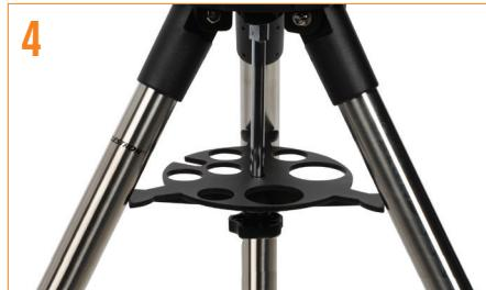
Far scorrere il vassoio porta-accessori sull'asta filettata in modo che ciascun braccio del vassoio spinga contro ciascuna gamba del treppiede. Posizionare nuovamente e serrare la manopola di blocco del supporto per le gambe per fissare saldamente il vassoio in posizione.
