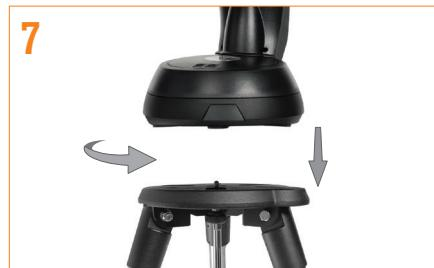
Coloque la base del telescopio sobre el cabezal del trípode de forma que el agujero del centro de la base de montaje se alinee con la punta de posicionamiento en la parte superior del trípode. Gire el soporte del telescopio de forma que las 3 patas de goma se alineen con los 3 recesos en la placa de montaje del trípode.
