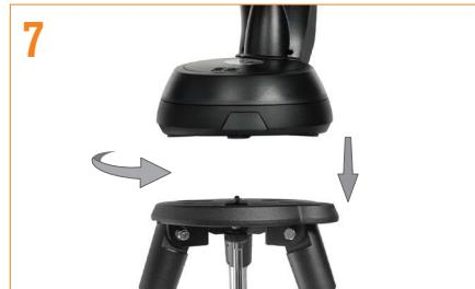
Placez la base du télescope sur la tête du trépied de sorte que le trou au centre de la base de la monture s'aligne avec la goupille de positionnement sur le dessus du trépied. Faites pivoter la monture du télescope de sorte que les 3 pieds en caoutchouc s'alignent avec les 3 évidements de la plaque de montage du trépied.
